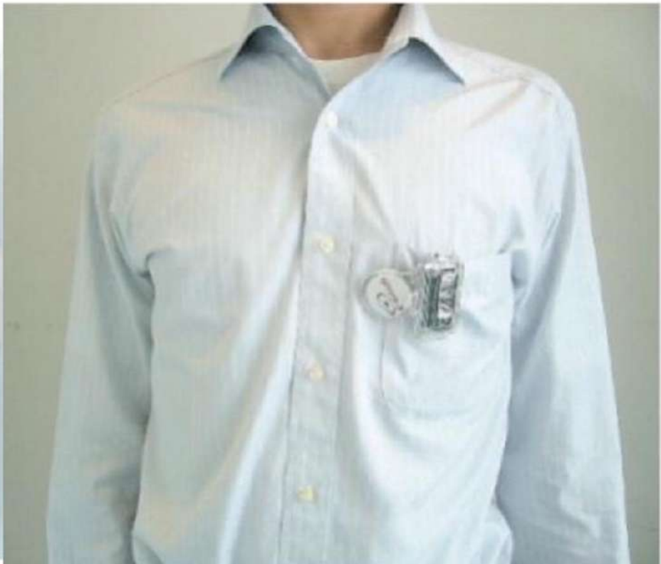
< เครื่องวัดรังสีที่ใช้สำหรับติดไว้บนร่างกาย ของผู้ที่ต้องปฏิบัติงานที่เกี่ยวข้องกับรังสี
